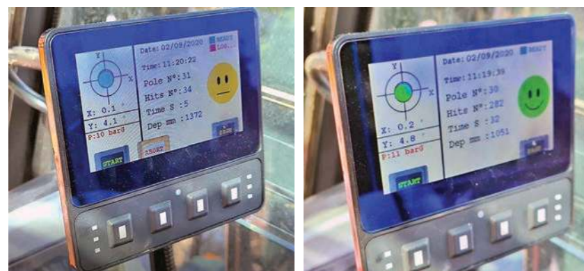
1A e 1B. Le sequenze di infissione in progress (1A) e di infissione corretta (1B)
