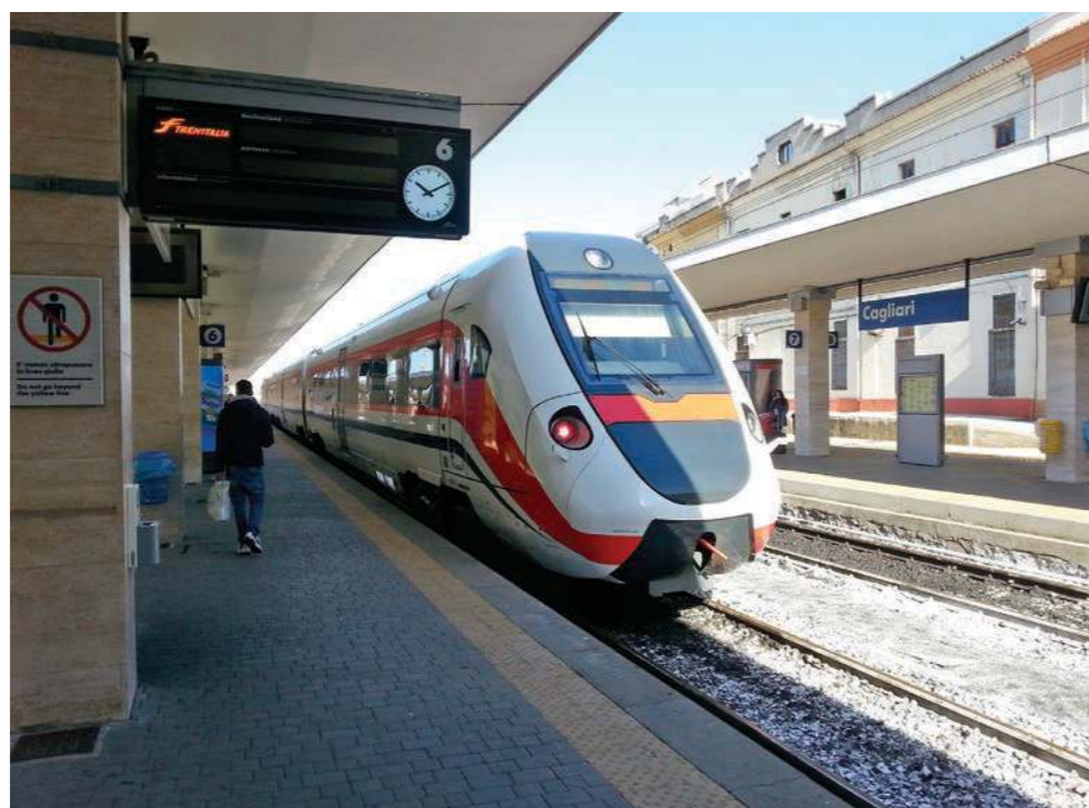
2. Un autotreno ATR 365 ad assetto variabile a trazione diesel per il servizio regionale costruiti dalla CAF per la Regione Sardegna
