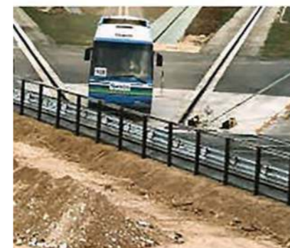
1A, 1B e 1C. La prima gamma di barriere stradali ANAS continue in un crash test su arginello ridotto (anno 2016)
