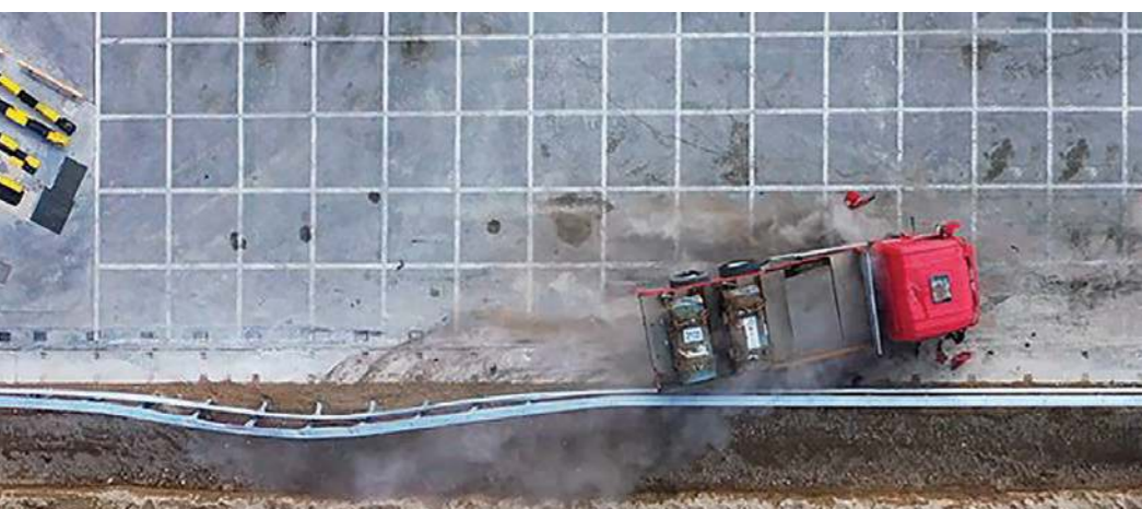
2. La nuova barriera stradale ANAS H3BL.D.AR in un crash test (Febbraio 2021)
