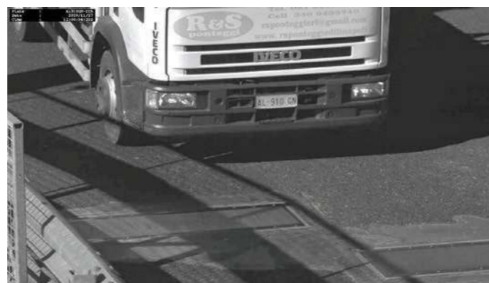
2. Un mezzo pesante in avvicinamento alle piastre di pesa dinamica
