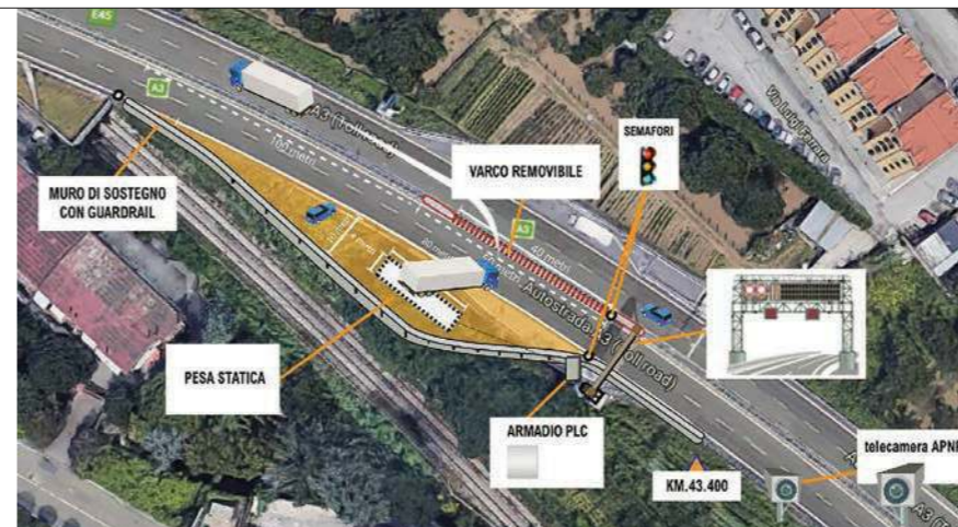
3. Descrizione del sistema di monitoraggio (piazzola)
