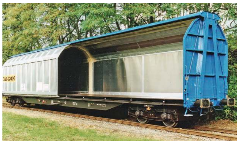
3. Il carro Transwaggon Habbiins-17 da quattro assi a carrelli
