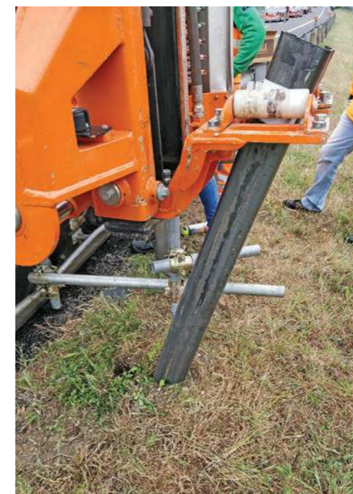
2A e 2B. Una prova di spinta su paletto della barriera effettuato in cantiere
