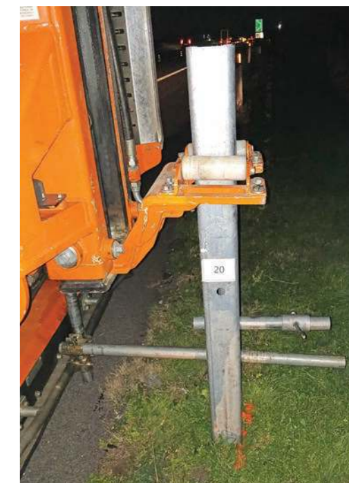
2A e 2B. Una prova di spinta su paletto della barriera effettuato in cantiere
