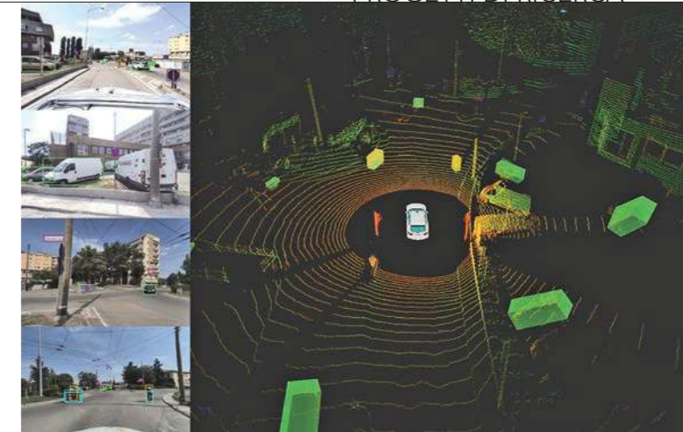
4. La sensor fusion interna al veicolo smart: sulla sinistra i punti di vista delle telecamere a bordo veicolo e a destra i parallelepipedi rappresentano i road users individuati dalle telecamere e dal LiDAR
