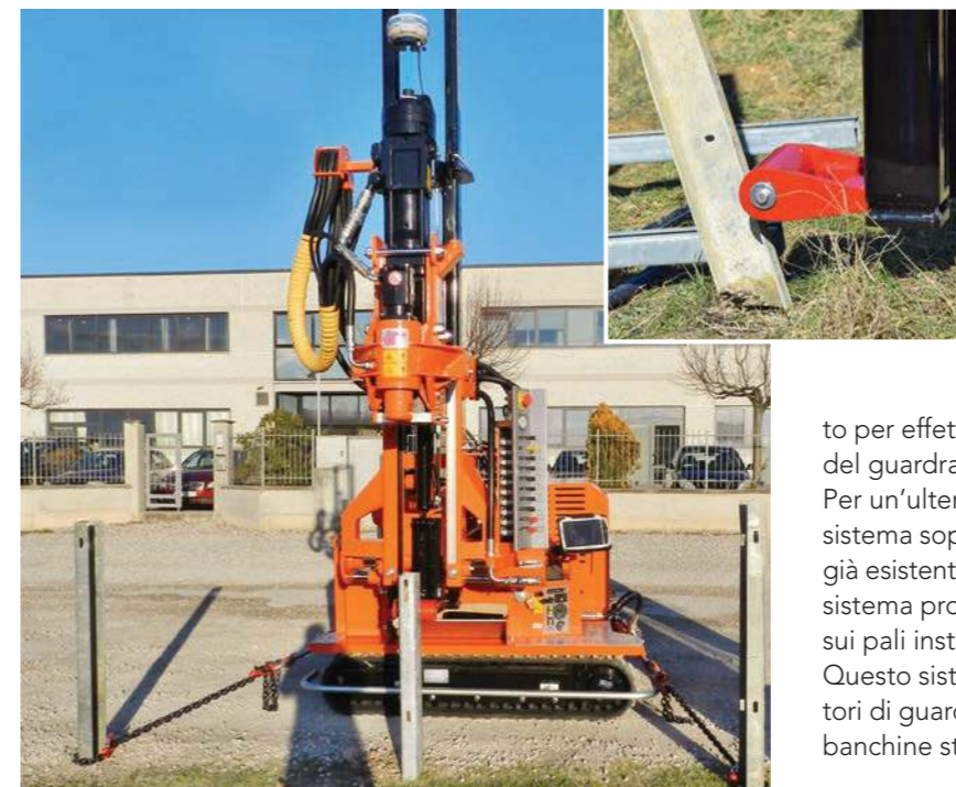
3A e 3B. I sistemi di prova paletti (3A) e di spinta del palo (3B)
